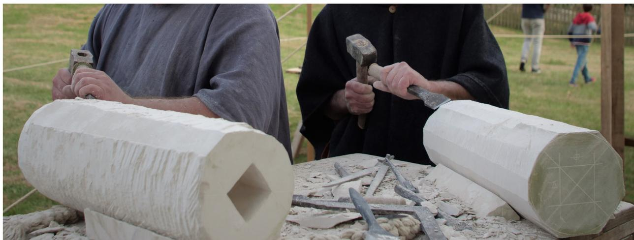
**Fig. 8 :** Taille circulaire au ciseau grain d'orge et épannelage hexadécagonal au ciseau droit. Crédit C. Billault.
