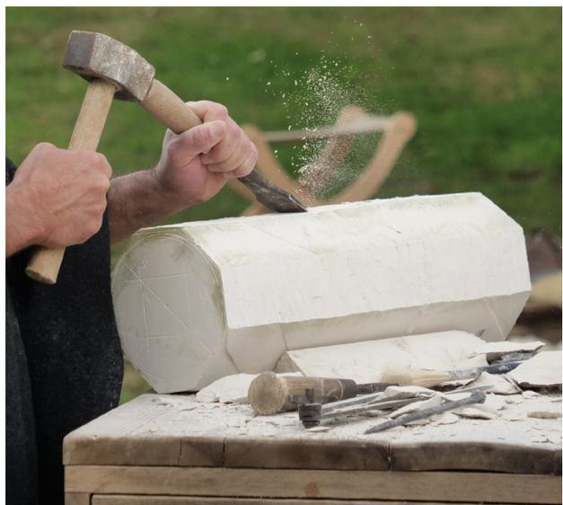
**Fig. 7 :** Épannelage octogonal au ciseau plat. Crédit C. Billault.
