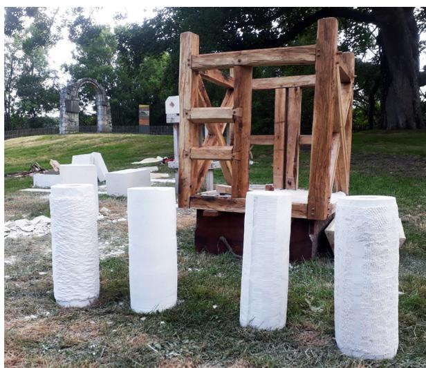
**Fig. 9 :** Face au tour, de gauche à droite : un tambour épannelé puis dégrossi à la polka, un tambour après tournage, un tambour à épannelage hexadécagonal réalisé au ciseau plat et un tambour épannelé puis dégrossi au ciseau grain d'orge. Crédit N. Revert.
