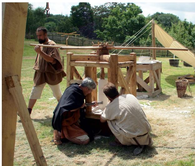
**Fig. 3** : Vue du tour à colonne en cours de fonctionnement une fois assemblé. Crédit C. Billault.
